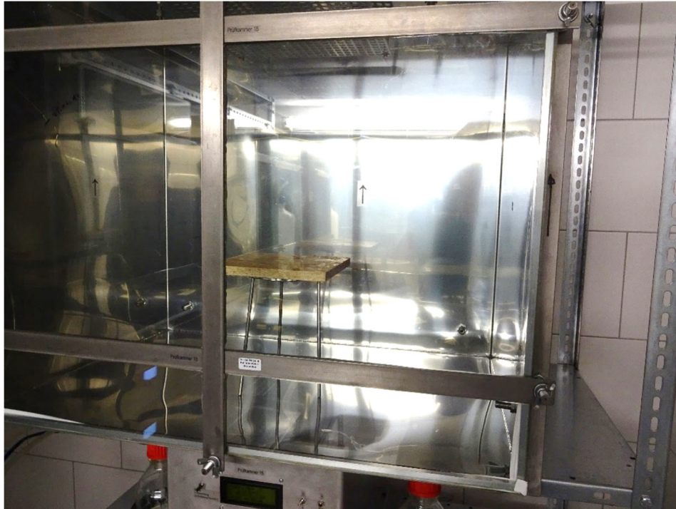
Abb. 3: 250 L Emissionsprüfkammer mit eingebrachtem Prüfstück (dotierte OSB Platte)
